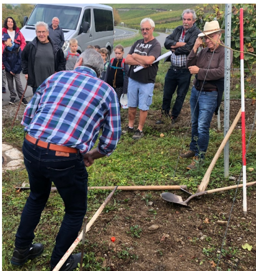
Feldgeschworener Obmann Roland Englert erklärt die Grundausrüstung der Werkzeuge: Senkel, Fluchtstab, Spaten, Haue und Auslage (2 Eisen und Stab)
