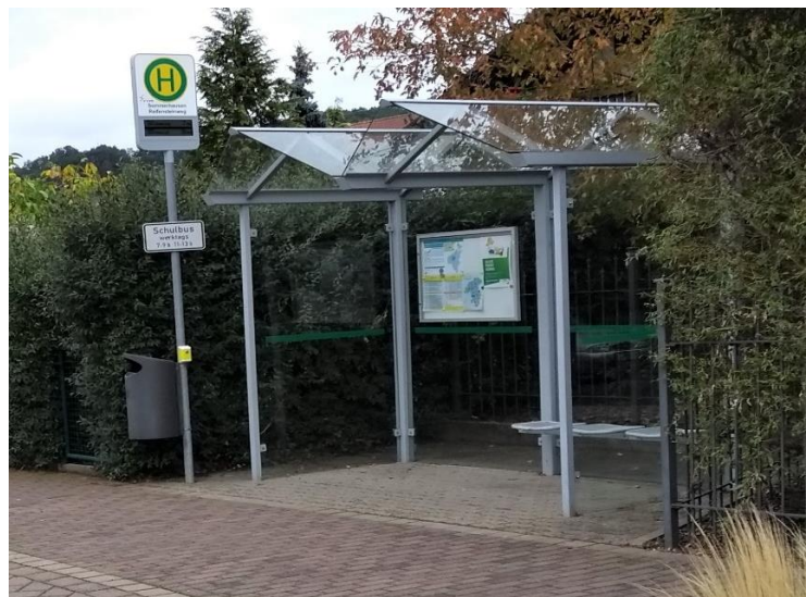
Abbildung 41: Bushaltestelle mit Wetterschutz, Sitzgelegenheit, Informationstafel, stationärer und dynamischer Fahrtzielanzeige und Sprachinformation auf Anforderung (Beispiel Sommerhausen)
